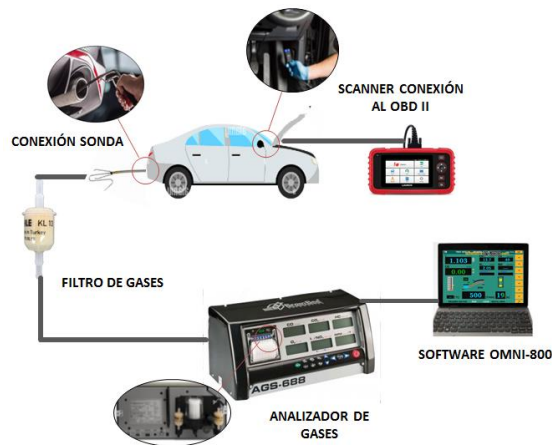
Figura 5: Conexión del analizador de gases y el scanner al vehículo. Fuente: Autores, 2024
