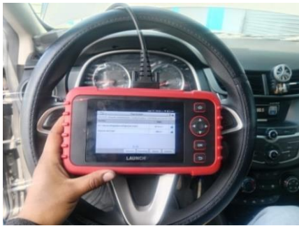
Figura 3: Conexión del Scanner al OBD II Fuente: Autores, 2024
