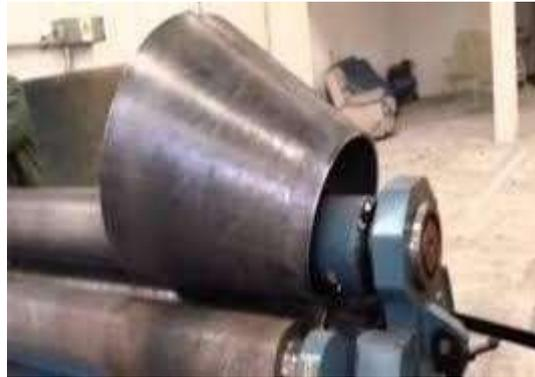
*Figura 4: Fabricación de conos para decantadores
