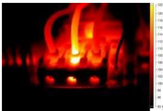
*Figura 1: Puntos calientes en tableros eléctricos
