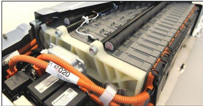
**Figura 2:** Batería híbrida HV
