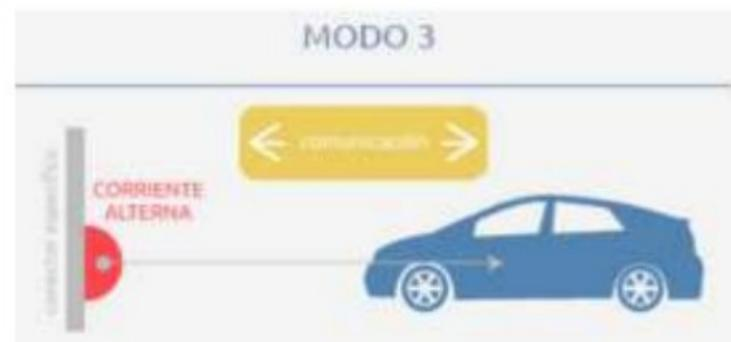
Figura 7: Esquema del modo de carga 3.
