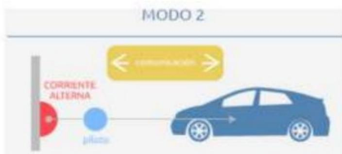
Figura 6: Esquema modo de carga 2.
