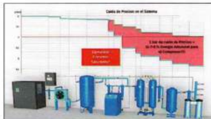
Ilustración 3 Pérdida de presión (Atlas Copco, 2017)
