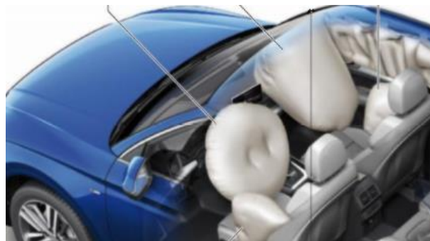
Figura 1: Activación de los airbags frontales del conductor y acompañante. Fuente: (Forum.audi.com, 2014)
