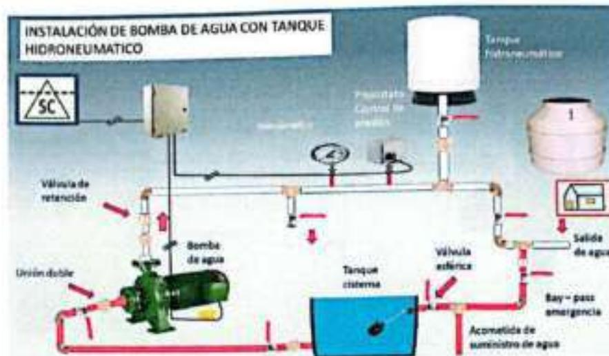
*Nota:* Conexión de una bomba hidroneumática (homedepot, 2023)
