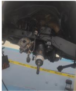
Figura 10: Desmontaje de mesas y amortiguadores vehículo pick up
