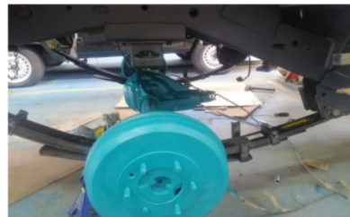
Figura 14: Montaje de ballestas y corona
