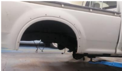
Figura 11: Desmontaje ballestas y amortiguadores vehículo pick up
