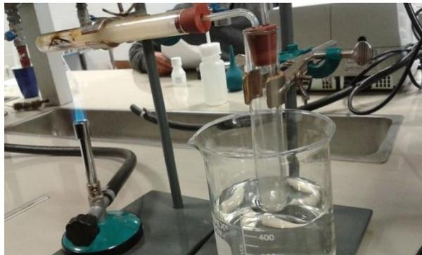
Figura N° 3 Obtención de biocombustible a partir de la madera.
