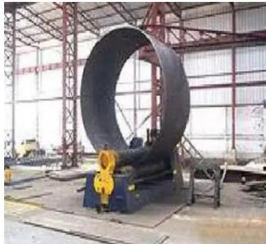
Figura 2 Lámina metálica de Trabajo Rolada
