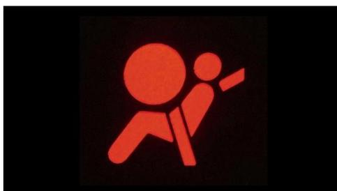
Figura 1. Luz testigo del sistema SRS
