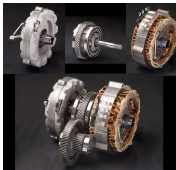
Figura 2 Conjunto moto-generator Fuente: keyslamer, 2009
