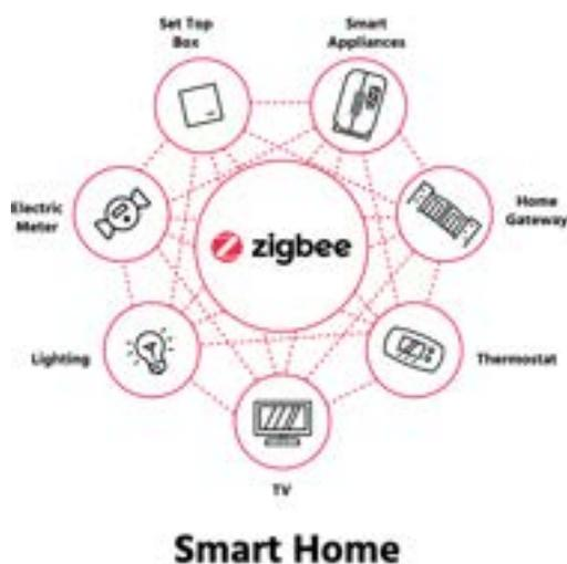
**Nota:** La figura 3 representa la comunicación entre diversos dispositivos del hogar a través del estándar zigbee el cual crea una red LAN, en la que se centra en una pantalla que controla el resto de dispositivos. (Connectivity Standards Alliance, 2024).
