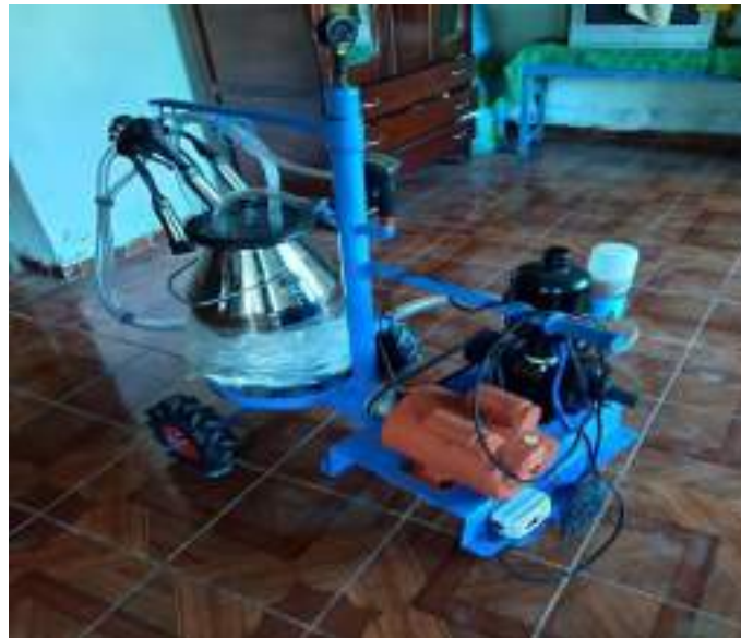
Figura 5. Sistema de ordeño automatizado
