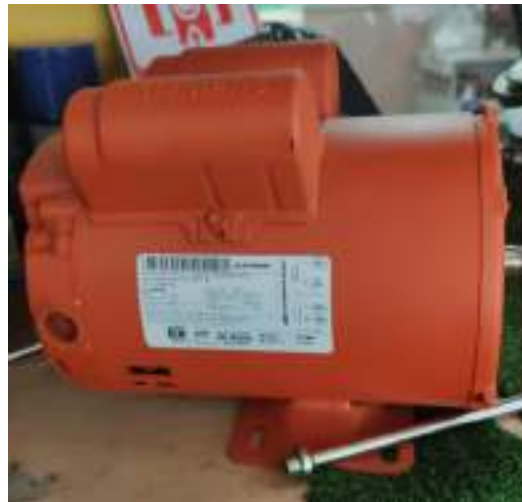
Figura 28. Bomba de vacío
