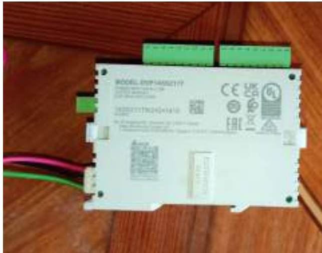
Figura 17. Controlador lógico programable (PLC)
