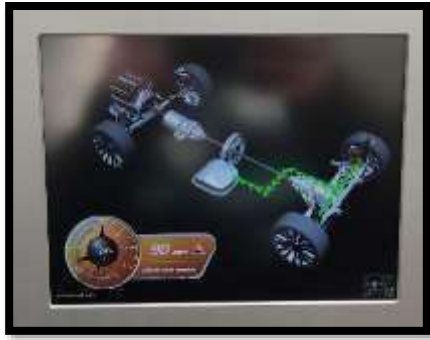
Figura 17. Bateria con 24% de carga a 90 km/h.
