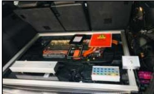
*Nota.* En la imagen se puede observar la batería híbrida del Audi Q5 (Autor,2022)
