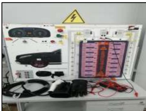
*Nota.* En la imagen se puede ver el módulo de carga y descarga de las batería de alto voltaje (Autor,2022)
