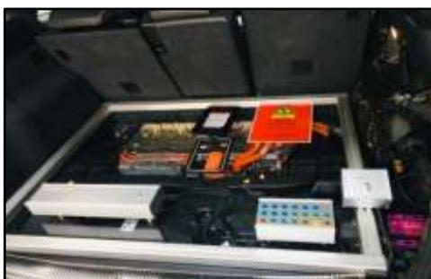
*Nota* En la imagen se puede observar la batería del vehículo híbrido Audi Q5 (Autor,2022).
