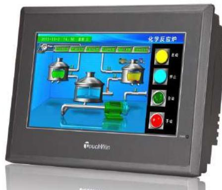
Figura 2. Ejemplo de un HMI
