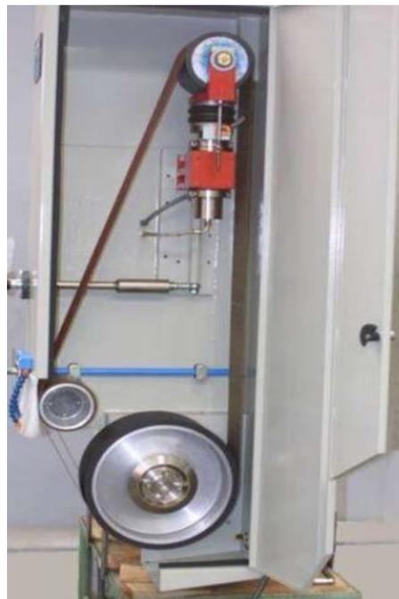
Figura 1: Máquina lijadora de banda.
