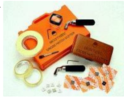
Figura 6 Medidor adherencia mediante cinta
