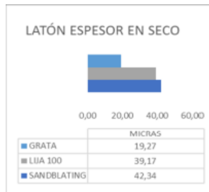
Figura 12 Promedio de espesores basados con los métodos de limpieza superficial usados en el latón
