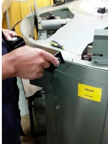
Figura 3: Mando de control a distancia de la máquina encoladora pony Müller Martini.
