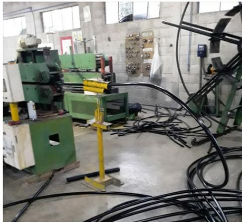
Figura 1. Máquina extrusora de manguera.
