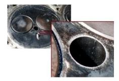
Figura 1 Deformaciones y grietas en una culata
