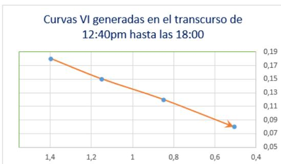
Figura 6.- Curva V-I entre las 12:40 a 18:00 con carga de 100 Ohmios.
