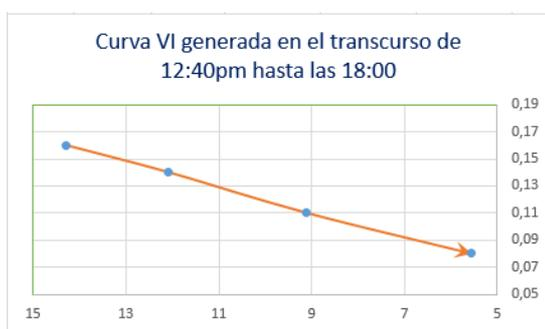
Figura 4.- Curva V-I entre las 12:40 a 18:00 con carga de  $100\Omega$ .
