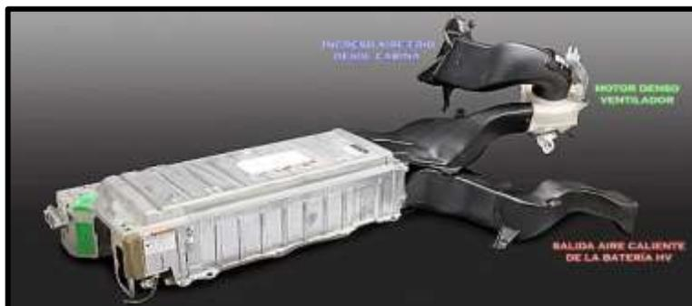
**Nota:** En la ilustración 11 se verifica los componentes de la refrigeración de las baterías HV.
