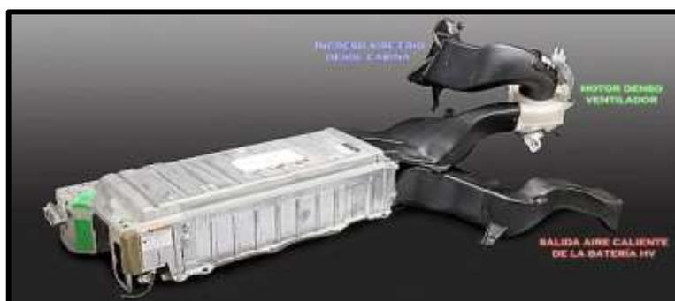
**Nota:** En la ilustración 1 se verifica los componentes de la refrigeración de las baterías HV. (Andrés, 2018)
