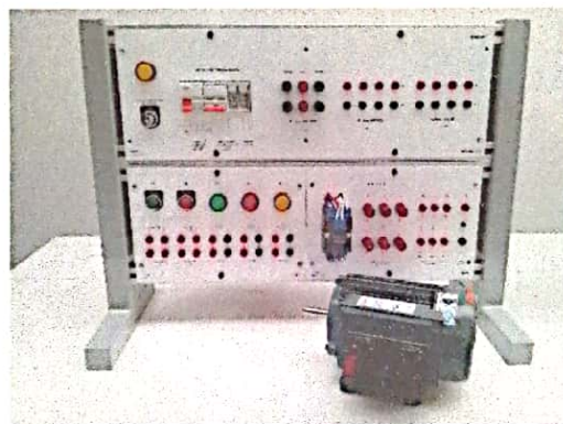
Ilustración 1. Tablero para el arranque de un motor.
