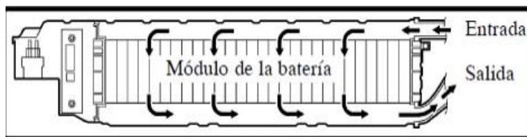
Figura 3 Flujo de aire enfriado para refrigeración de las baterías HV
