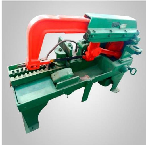
Figura 1 Sierra mecánica de arco. (Inprometser, 2017)
