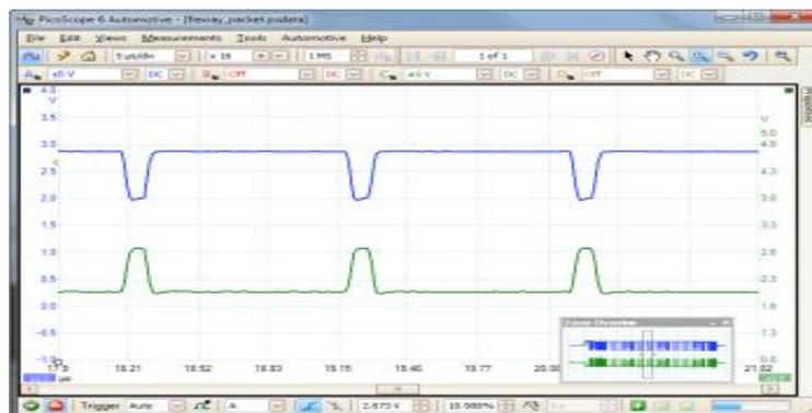
*Ilustración 2 Onda típica del protocolo FlexRay*
