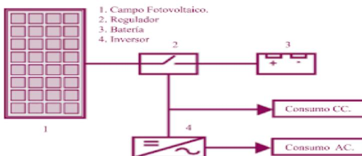
**Figura 3:** Componentes de un sistema fotovoltaico
