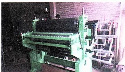
Figura 4 máquina micro-corrugadora
