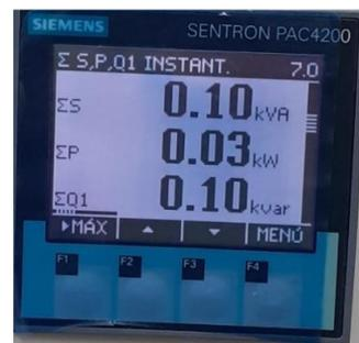
Figura 9. Medidor de energía SENTRON PAC 4200
