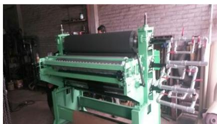
**Figura 4** máquina micro-corrugadora
