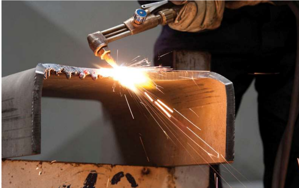
Ilustración 1 Calentamiento del material
