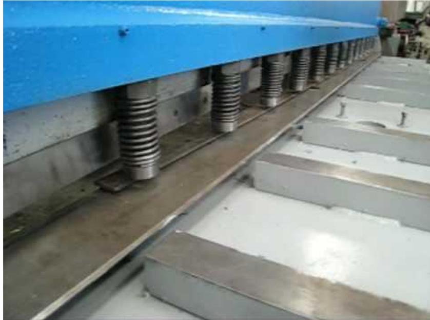
Figura 1.2 Rodríguez, C.(2014). Ilustración de Pisadores Hidráulicos de una Cizalla. Recuperado de <http://mimaquinaria.com>
