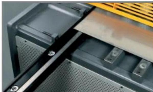
*Figura 1.6 Marin, J.(2006). Ilustracion de Bolas de Deslizamiento de una Cizalla. Recuperado de manual de Cizallas y Guillotinas Hidráulicas HACO*
