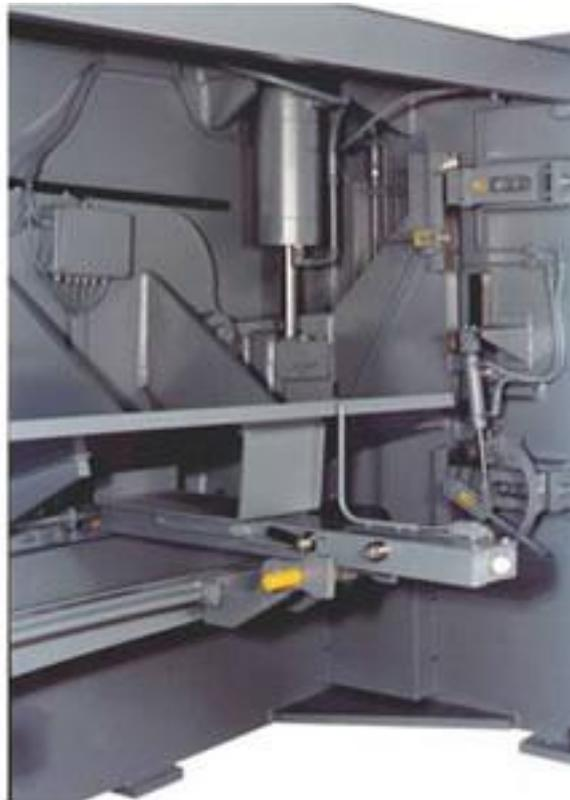
*Figura 1.1 Marin, J.(2006). Ilustracion de Sistema Hidráulico de una Cizalla. Recuperado de manual de Cizallas y Guillotinas Hidráulicas HACO*
