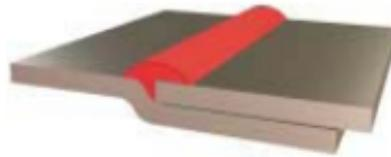
*Ilustración 7: Junta de solapado*
