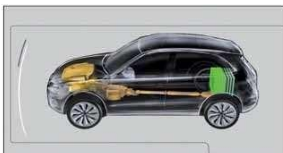
Figura 5.- Conducción carga de la batería mediante MCI.
