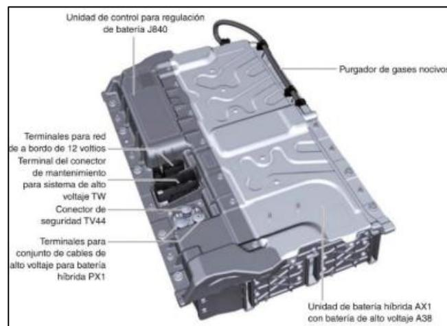
**Figura 5.1.1** Batería de alta tensión de un Audi Q5
