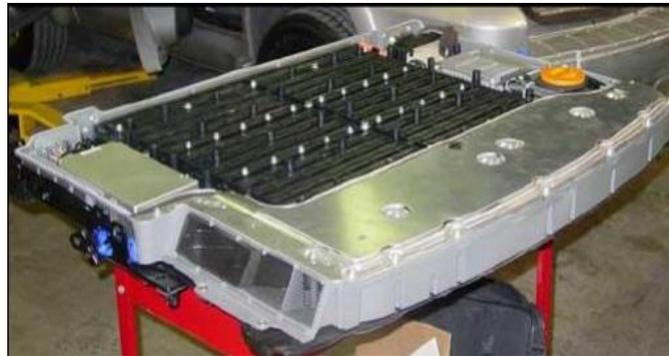
**Figura 5.6** Conjunto de batería HV
