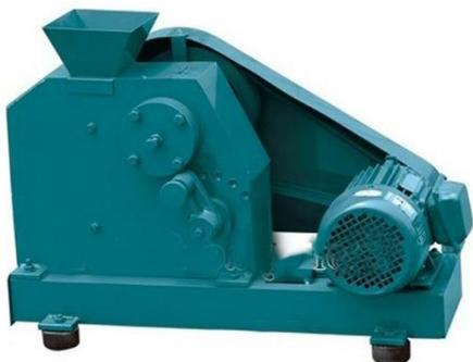
Diseño y construcción de una máquina trituradora de vidrio reciclado las siguientes dimensiones de la maquina 1.50m de alto por 1m de ancho y tiene una capacidad de 10kg de vidrio durante su proceso.
