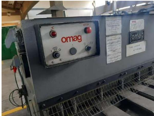
*Figure 2 Cizalla hidráulica modelo CESOIA OMAG OLEODINAMICA CE 156 S*
