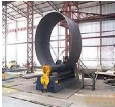
Figura 2 Lámina metálica de Trabajo Rolada
