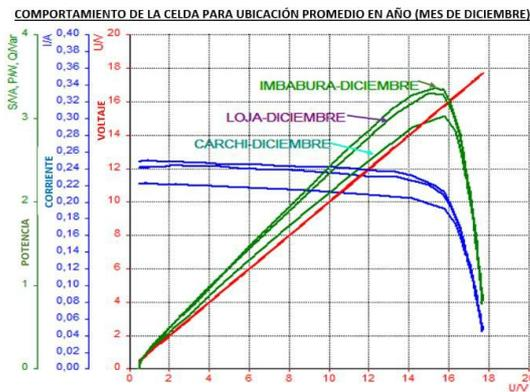
Figura 3: Comportamiento del panel en experimento.
