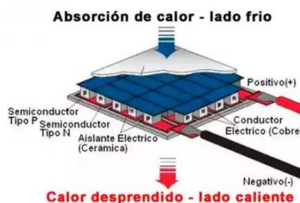
Figura 1. Célula Peltier Fuente: Gomar, J. (2018).
