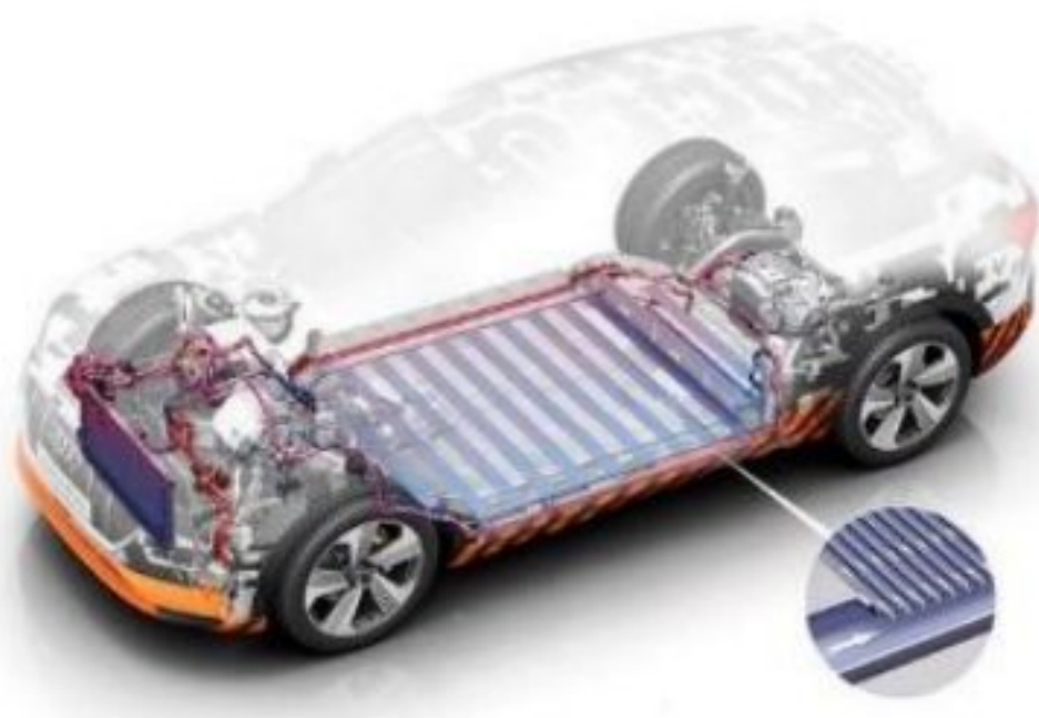
Figura 2. Gestión térmica de la batería. Fuente: García, G. (2019)
