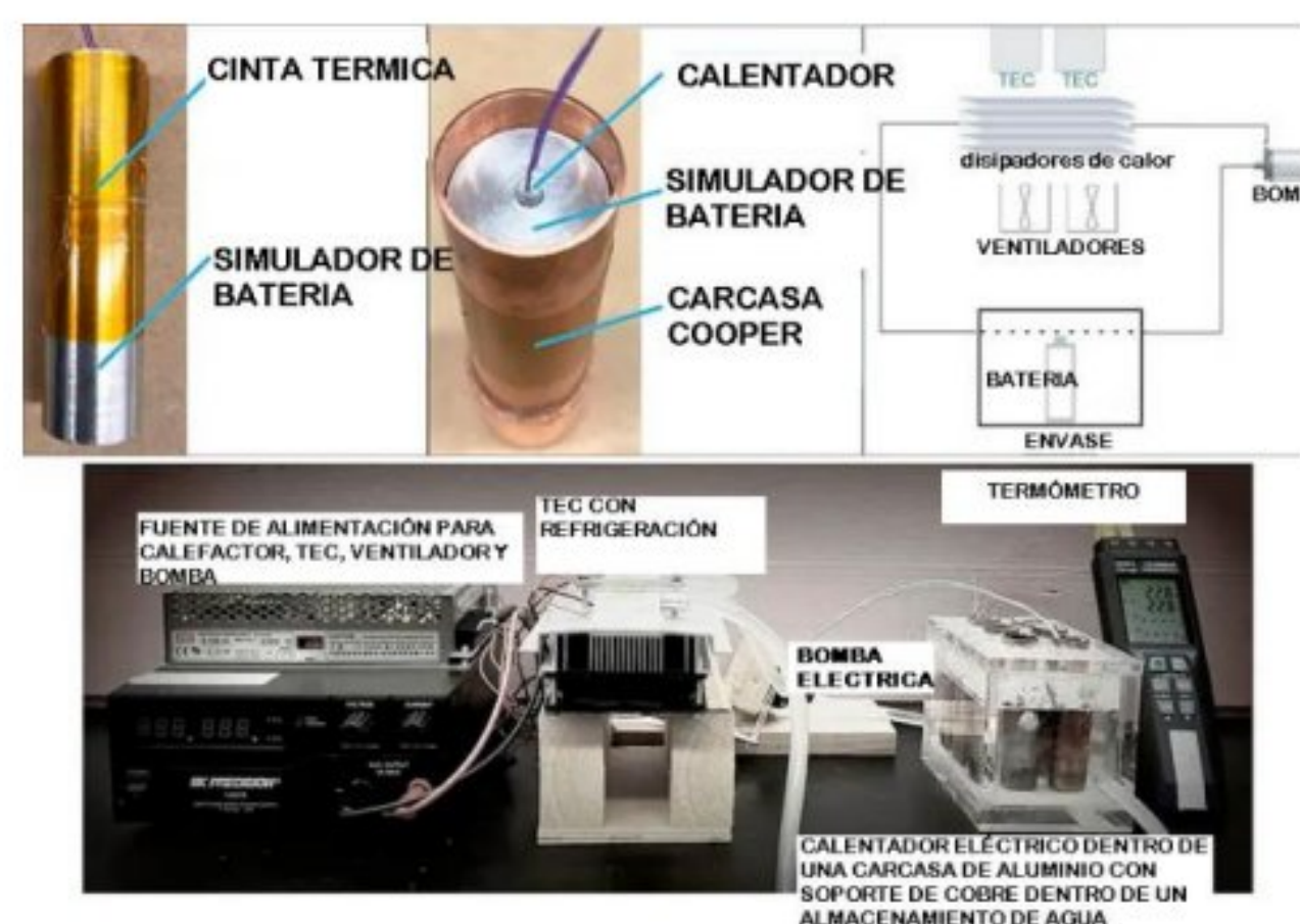
Figura 4. Sistema experimental de enfriamiento termoeléctrico.
