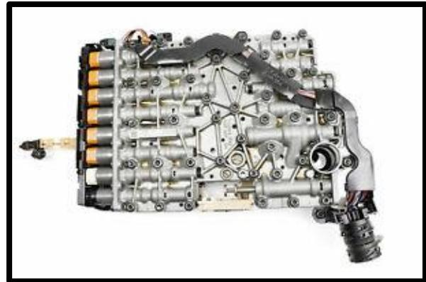
Figura 3 Estructura interna de la transmisión del Audi Q5
