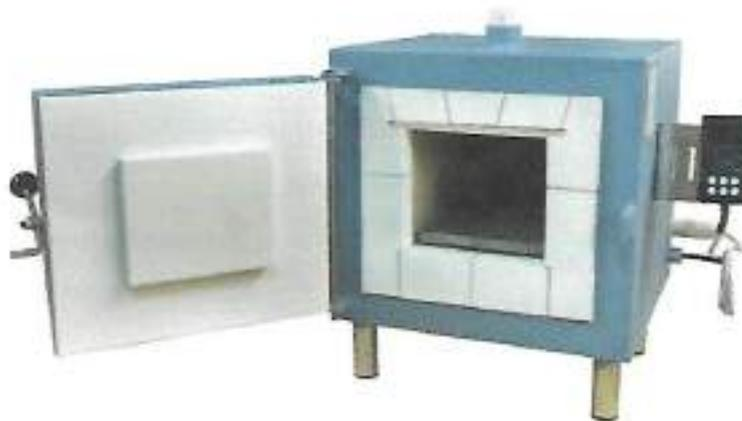
*Figura 1. Horno eléctrico para fundición*
